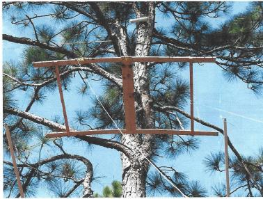
28.000 SWR 1.6 R=79 X=11 28.300 SWR 1.4 R=66 X=15 28.500 SWR 1.3 R=64 X=10 29.000 SWR 1.4 R=65 X=14
